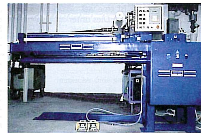
Bild 4 Plasma-Bandschweißanlage mit Schneideinrichtung, induktiver Glühvorrichtung, Walzeinrichtung und Längsnaht-Vorrichtung zum Plasmaschweißen von Rohren in der Klimatechnik.
