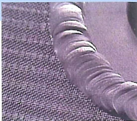
Bild 2 Verbindung unterschiedlicher Werkstücke, Mikroplasma manuell mit Kaltdraht.
