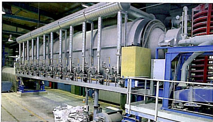
Rund 30 verschiedene Schweißpulver fertigt Oerlikon mit der neuen Produktionsanlage Bild: Oerlikon
