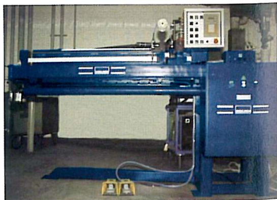
Diese Plasma-Bandschweißanlage mit Schneideinrichtung, induktiver Glüheinrichtung, Walzeinrichtung und Längsnaht-Vorrichtung wird zum Plasmaschweißen von Rohren in der Klimatechnik eingesetzt.
