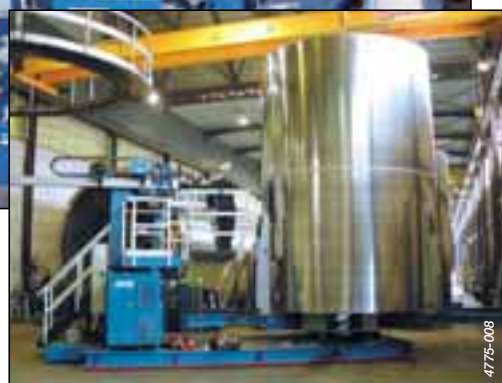
Edelstahl-Behälter mit Keyhole- Plasma-Verfahren geschweißt
