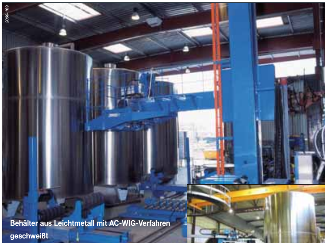
Edelstahl-Behälter mit Keyhole- Plasma-Verfahren geschweißt
